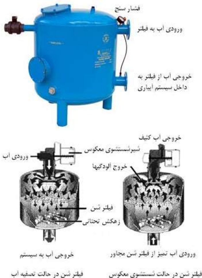
شکل (۵) - نمایی از فیلترهای شنی و چگونگی عملکرد آنها در دو وضعیت تصفیه آب و شستشوی معکوس
